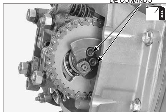
FERRAMENTA LIMITADORA DO ACIONADOR DO TENSOR
