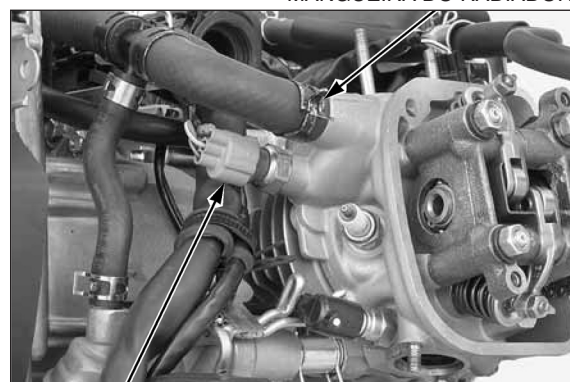
CONECTOR 3P (CINZA) DO SENSOR ECT
