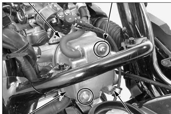
TAMPA DO CABEÇOTE PARAFUSO DA BRAÇADEIRA DA MANGUEIRA DE COMBUSTÍVEL TAMPA DO CABEÇOTE
